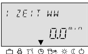
Drücken der Taste "Warmwassertemperatur"
