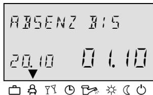
Mittels dieses Modus kann die Heizung vorübergehend für die Zeit der kurzen Abwesenheit ausgeschaltet werden. Während der Zeit der Abwesenheit werden alle Heizkreise in Übereinstimmung mit spezifizierter Raumtemperatur gesteuert. Nach Ablauf der eingestellten Zeit kehren die Heizkreise automatisch in Betriebsmodus zurück, der vor der Einstellung des Modus „Absenz“ aktiv war. Kurzfristige Programme wie *Party* (Besuch) oder *Urlaub* werden in diesem Modus ausgelassen.
