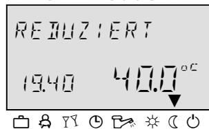
Dieser Modus bietet dauernd begrenzte Heizung nach eingestellter Raumdämpfungstemperatur, die dem Modus ECO (Modus mit ausgeschaltetem Frostschutz) oder ABS (beschränkter Modus), die im Heizkreis nach unterer Grenze des entsprechenden Heizkreises entspricht.
