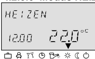
Dieses Programm bietet ununterbrochene Heizung nach eingestellter Tagesraumtemperatur. Die Warmwassererwärmung funktioniert ununterbrochen nach eingestelltem Wert für Warmwassererwärmung.
