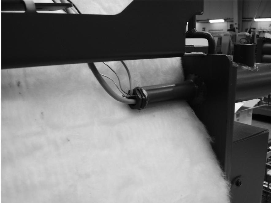
Sensor der Kesseltemperatur WF in Schutzhülse, zugegeben zu sonstigen Sensoren der Thermostate ursprünglicher elektromechanischer Kesselregelung
