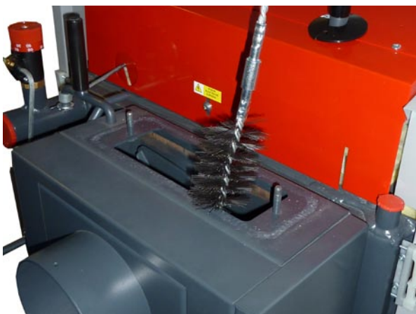
Vorführung der Reinigung des Rauchkanals mit Drahtbürste.
