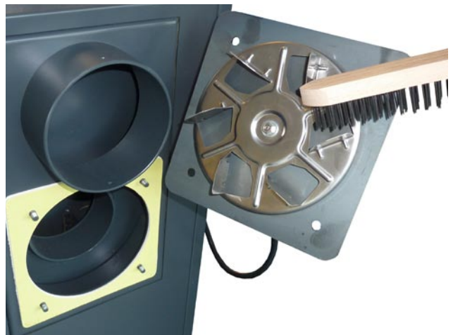
Die Reinigung des Umlaufrad und die Kontrolle des Schaufels bei Saugzugventilator (bei P31)
