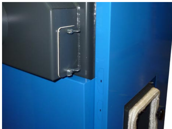
Steckverbindungen in der rechten Kesselabdeckung
