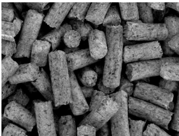
Mangelhafte Holzpellets – dunkle mit Rinde (mit schwarzen Punkten)
